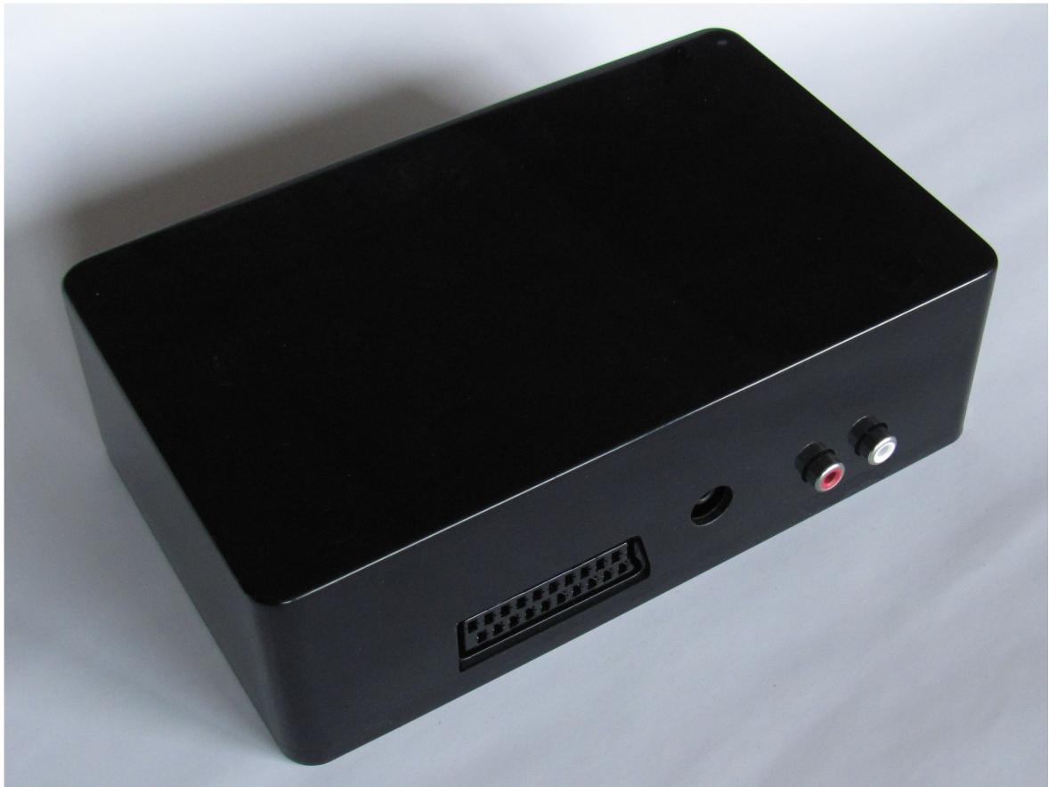
Слика 1. Етернет уређај за дигитализацију и дистрибуцију SDTV сигнала
