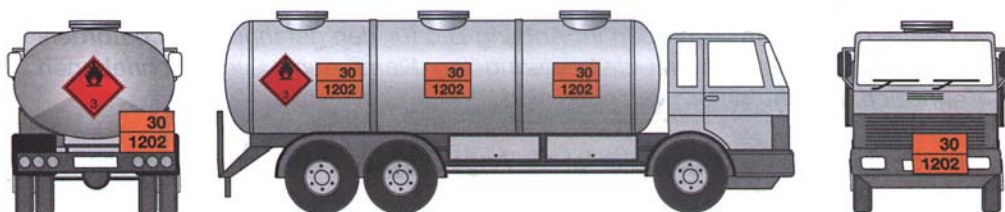
Slika 10. Obeležavanje vozila: vozilo cisterna sa istom materijom u svim komorama
