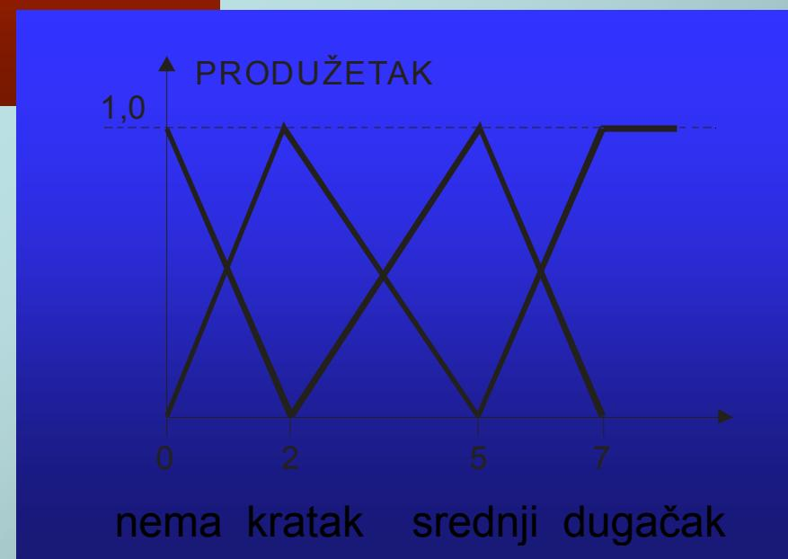
**Fuzzy zaključivanje** se unutar samog kontrolera sprovodi (min-max) metodom, odsecanja (min.), a na izlaznom fuzzy skupu se dobija zaključak (max. - osenčena površina).
